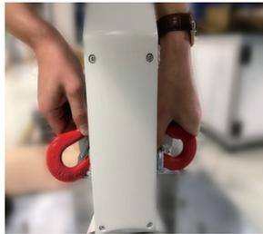
步骤 2：吊装绳索②穿过机器人小臂部位后，绳索两头挂扣在缆绳①的挂钩上，该挂钩带防松功能，如下图所示：
